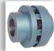
Elastische Klauenkupplungen ELKU, ELKU-N Dreh- und biegeelastische Steckkupplungen in zwei- und dreiteiliger Ausführung mit Bremstrommel, mit Bremscheibe, mit Zwischenstück 25 Nm - 100.000 Nm
