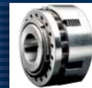
Lamellensicherheits- und Lamellenanlaufkupplungen LASI, LAAN drehmomentbegrenzende Lamellenreibungskupplungen für Trocken- und Nasslauf, wahlweise auch in Kombination mit elastischer Verbindungskupplung 25 Nm - 25.000 Nm
